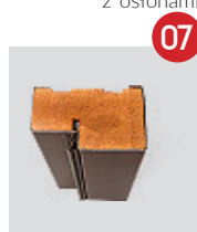
07 Ościeżnica stalowo-drewniana składająca się z blachy ocynkowanej o grubości 0,6 - 1,2 mm oraz klejówki sosnowej, laminowana w kolorze skrzydła, wyposażona w uszczelkę
