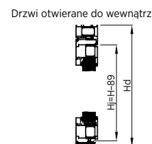
Rys. 54. Światła przejścia Hj dla drzwi DECO Plus z doświetlaniem bocznym
