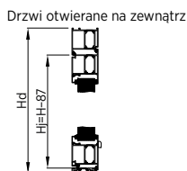
Rys. 42. Światła przejścia Hj dla drzwi DECO Basic bez doświetli
