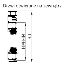
Rys. 54. Światła przejścia Hj dla drzwi DECO Plus z doświetlaniem bocznym
