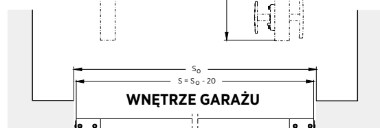
Rys. 36. Montaż bramy jednoskrzydłowej w otworze – przekrój poziomy.
