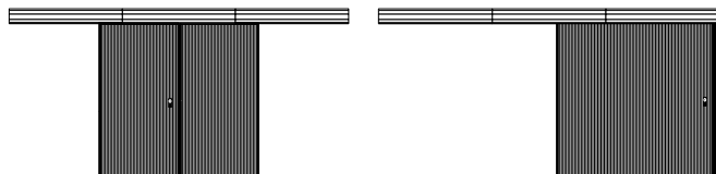
Rys. 1. Brama podwieszana przesuwna dwuskrzydłowa, (symetryczny podział skrzydeł). Rys. 2. Brama podwieszana przesuwna jednokrzydłowa lewa, brama w pozycji zamkniętej.
