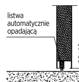
Rys. 19. Przekrój przez listwę opadającą
