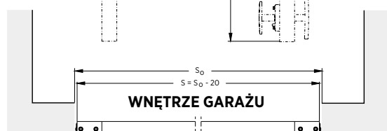
Rys. 36. Montaż bramy jednoskrzydłowej w otworze – przekrój poziomy.
