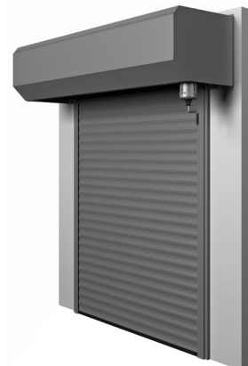
Rys. 15. Skrzynka zewnętrzna dla bramy z siłownikami SI 40, 55, 75. Awaryjne otwieranie korbką lub przekładnią łańcuchową.
