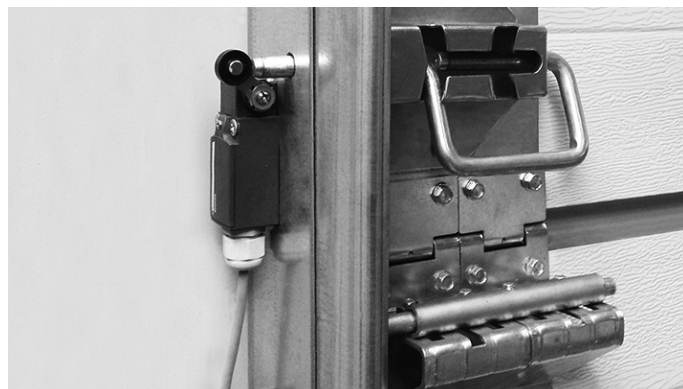
Rys. 38. Przykład montażu czujnika otwarcia zamka/rygla.
