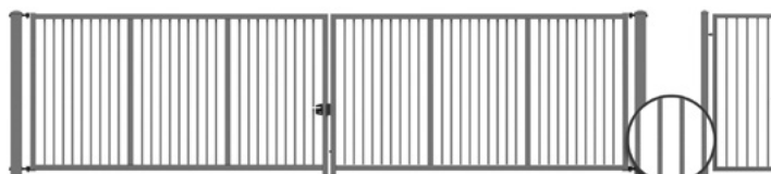
Rys. 11. Brama dwuskrzydłowa z wypełnieniem w postaci kształtowników zamkniętych 25x25 [mm] Caro, spawanym do konstrukcji.
