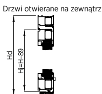
Rys. 50. Światła przejścia Hj dla drzwi DECO Plus bez doświetli
