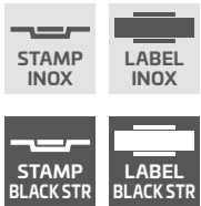
Tłoczenie dwustronne o szer. 25 mm z intarsją w wykończeniu INOX lub malowaną na czarno. Intarsja może być zamontowana jednostronnie lub dwustronnie. Umieszczona jest w tłoczeniach i jest zlicowana ze skrzydłem (STAMP) lub naklejona na płaskim skrzydle (LABEL).
