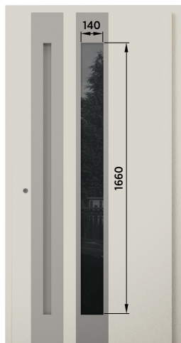
Jednostronny uchwyt pionowy dł. 1660 [mm]
