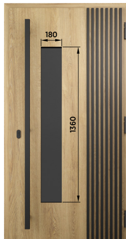
Aplikacje w postaci lameli o szer. 20 [mm]
