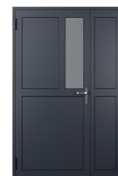
Drzwi dwuoskrzydłowe stalowe profilowe zewnętrzne bez przegrody termicznej do pomieszczeń nieogrzewanych w systemie Forster Presto, wypełnienie G
