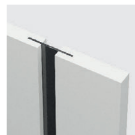
łączenie z szybą „na kant” skrzydło bezprzylgowe
